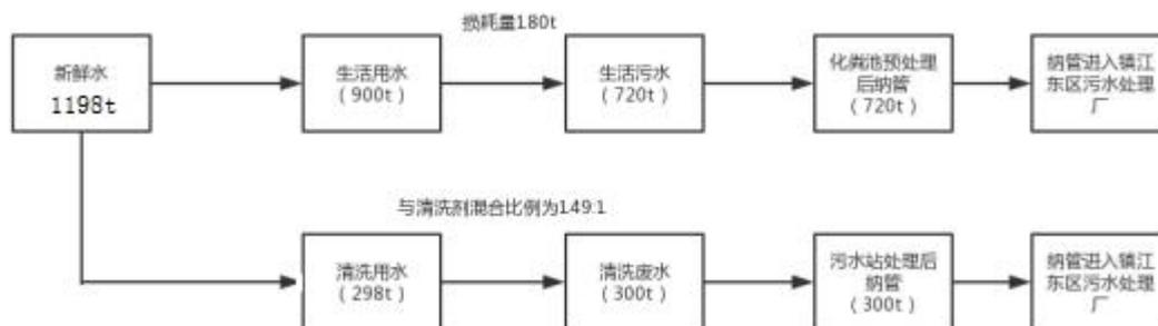
图 2-4 本项目水平衡图（单位：t/a）
