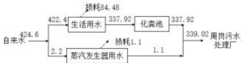
**图 2-1 项目水平衡图 (单位: t/a)**
