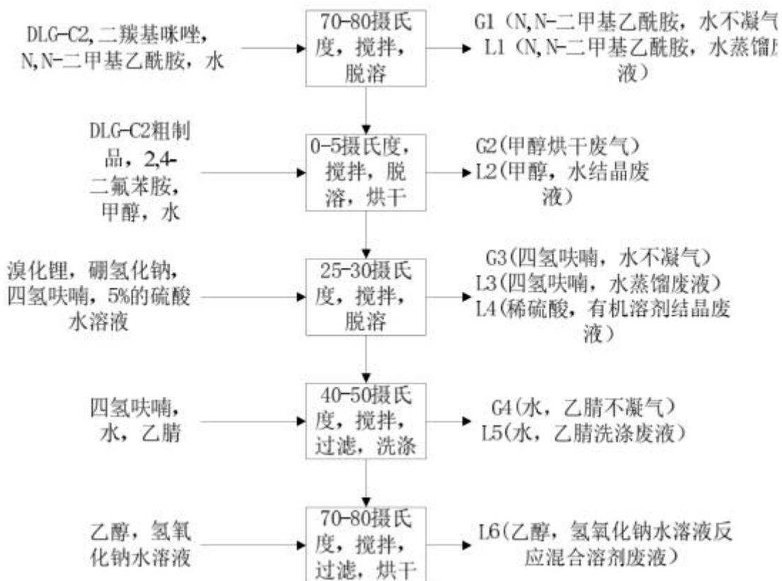
图 2-4 度鲁特韦 (Dolutegravir) 研发工艺流程及产污环节
