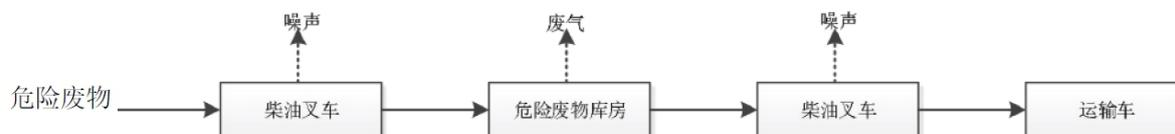
图 2-3 危废收集暂存流程及产污环节图
