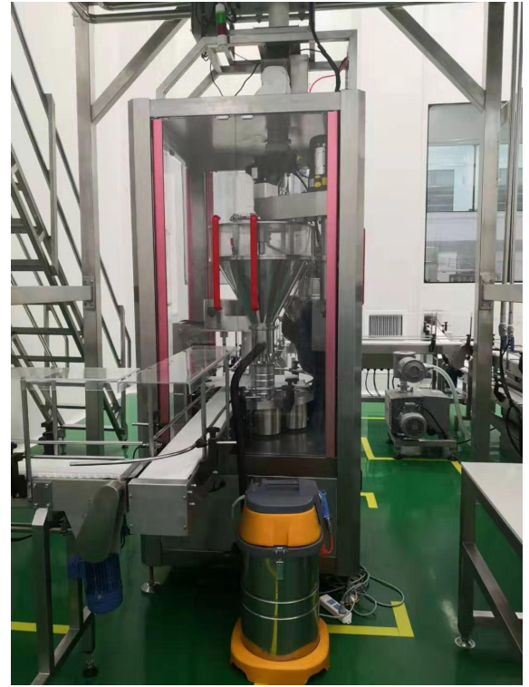
充填机过滤装置
